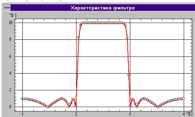
Рис. 9.34. Амплитудно–частотная характеристика полосового фильтра Чебышева–2 7-го порядка с флуктуациями 10%
