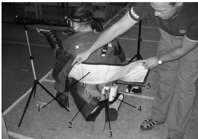
Рисунок 1.9. Фиксация КАРДиЗ-9 и датчиков для регистрации физиологических показателей при стрельбе с колена. 1 – стрелковая куртка; 2 – стрелковые штаны; 3 – адаптер КЗ-А1; 4 – КАРДиЗ-9; 5 – кабель соединительный с адаптером КЗ-А1.
