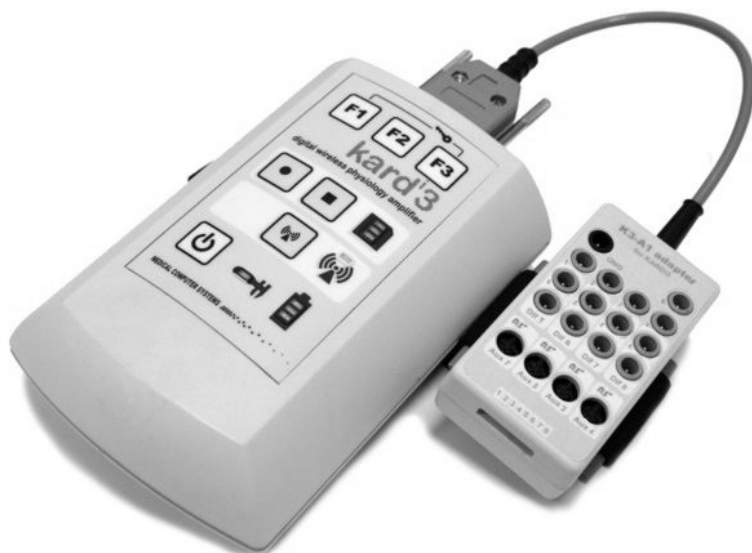
Рисунок 1.1. Цифровой беспроводной усилитель-полиграф КАРДиЗ-9. Общий вид.
