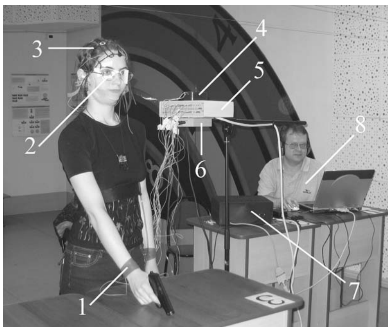
Рисунок 2.13. Общий вид экспериментальной установки для регистрации электрофизиологических показателей во время выполнения стрельбы в тире (25 м). Регистрация с помощью программно-аппаратного комплекса «CONAN-m». 1 – электроды для регистрации ЭКГ; 2 – электроды для регистрации ЭОГ; 3 – шлем-сетка и электроды для регистрации ЭЭГ; 4 – маркер выстрела; 5 – блок регистрации ЭЭГ, ЭОГ и ЭКГ; 6 – блок регистрации вегетативных показателей; 7 – блок усиления биопотенциалов; 8 – оператор.
