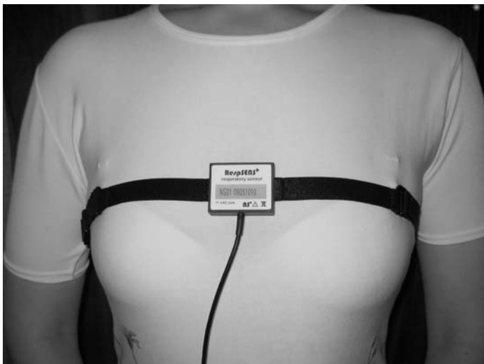
Рисунок 3.6. Расположение датчика грудного дыхания RespSENS.
