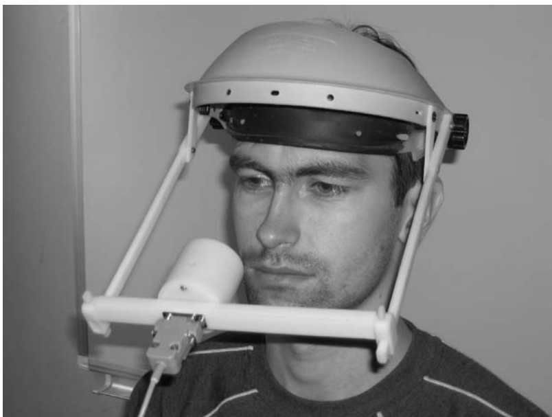
Рисунок 6.2. Общий вид комплекса для видеорегистрации движений глаз и измерения площади зрачка.
