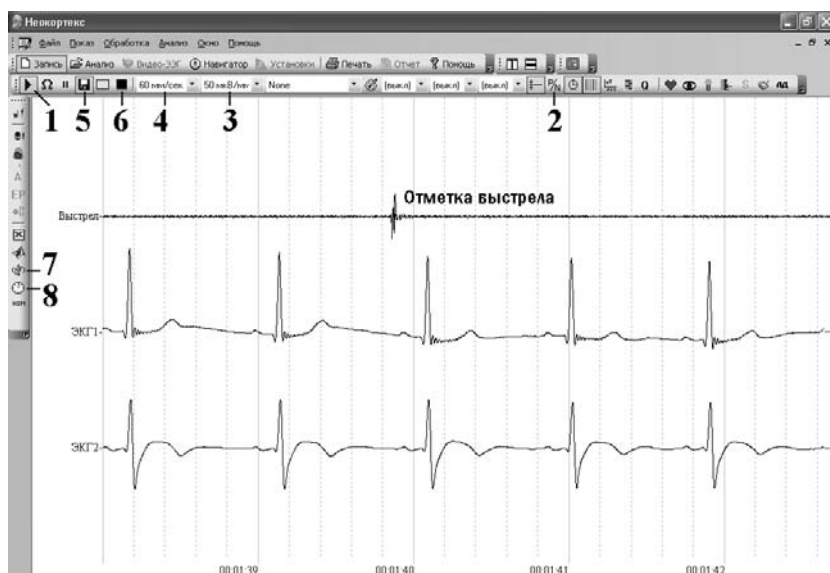
Рисунок 4.22. Регистрация электрокардиограммы в программе «Неокортекс» во время стрельбы из пневматического пистолета на тренажере «СКАТТ». По первому каналу записана отметка выстрела; по второму – ЭКГ при ФВЧ = 0.05, ФНЧ = 70; по третьему – ЭКГ при ФВЧ = 2, ФНЧ = 30.
